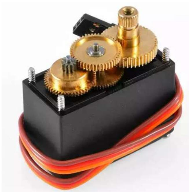
Рисунок 2 – Общий вид редуктора сервомашинки MG996R
